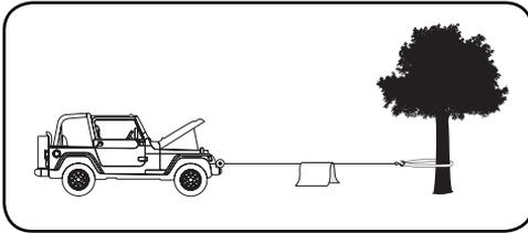
Dans le cas où la corde synthétique se romprait, cela permettra de réduire le contrecoup. Pour plus de protection, ouvrez le capot du véhicule. Pour les charges de plus de 50 % de la charge nominale du treuil, il est recommandé d'utiliser la poulie coupée (incluse) pour doubler la corde synthétique.
