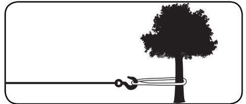
Le treuil est muni d'un guide d'aluminium pour guider la corde synthétique et réduire la courbure lors d'arrimage à courte distance. N'utilisez jamais le treuil dans un angle très prononcé, car la corde synthétique s'accumulera sur un côté du tambour causant des dommages à la corde synthétique et au treuil.
